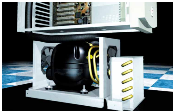
Der Unterbau mit Kompressor, Kondensor und den Lüftern.
