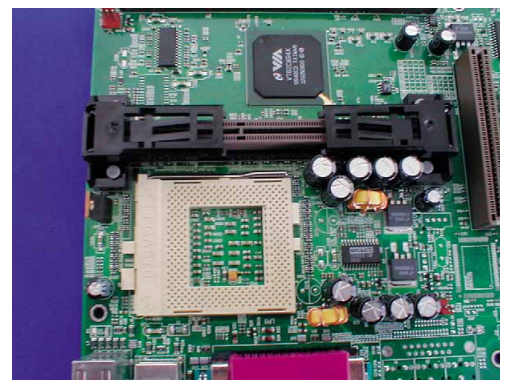
Intel kehrt dem Slot 1 (oben im Bild) als Prozessor-Steckplatz den Rücken und setzt in Zukunft wieder auf den quadratischen Sockel (darunter).
