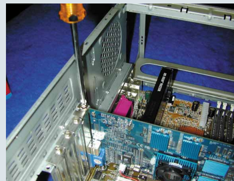
Schritt 5: Schrauben Sie die Karte am Gehäuse fest. Fertig! Nach einem Probelauf können Sie das Gehäuse wieder schließen.
