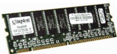
Speicherbausteine mit ECC-Korrektur-Chip sind wesentlich teurer als normale Module.
