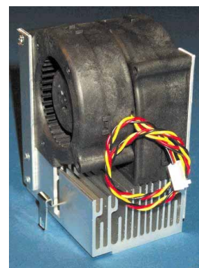
Die Wärmeabnahmefläche des Silverado-Kühlers besteht aus 50 Gramm reinem Silber.
