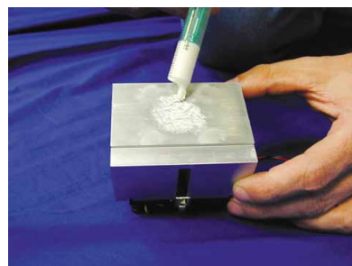
Schritt 4: Erst mit einer Schicht Wärmeleitpaste ist die optimale Wärmeabfuhr gewährleistet.
