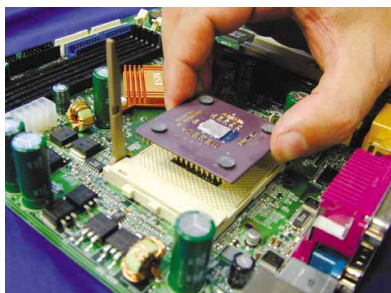
Schritt 5: Setzen Sie den neuen Prozessor mit Gefühl senkrecht in den Sockel ein.
