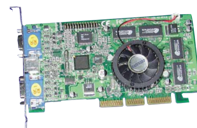
Bestückt mit 64 MByte 3,5-ns-Speicher, stellt die Geforce 2 MX TwinView von Gainward die schnellste erhältliche MX-400-Karte dar.
