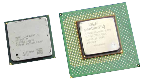
Neuer (links) und alter Pentium 4 im Größenvergleich: Die Grundfläche ist erheblich geschrumpft.
