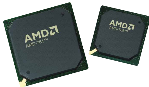
Als Pionier unter den DDR-Chipsätzen gilt der AMD 760. Neben dem SIS 735 ist er der Schnellste von vier DDR-Modellen.
