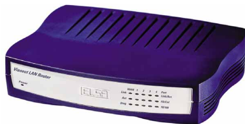
Router mit Switch wie der Elsa Vianect LAN Router verbinden einen ganzen Clan über eine DSL-Leitung mit dem Internet.
