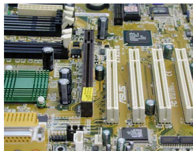
Moderne Grafikkarten gibt es nur noch für den AG-Port (braun), ältere Modelle wie die Kryo 1 auch für den langsamen PCI-Steckplatz (weiß).
