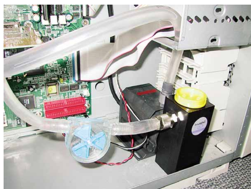
Vor der Pumpe entlüftet der Ausgleichsbehälter das Kühlsystem. Dessen Funktion können Sie mit dem Durchlauftester überprüfen.
