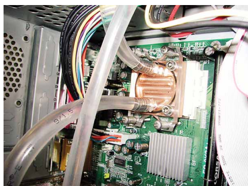
Eine Wasserkühlung senkt deutlich die Gehäusetemperatur – zusätzliche Lüfter sind meist überflüssig. Hier das CPU-Teil.
