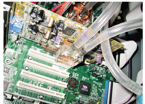
Auch die Grafikkarte, die Northbridge und sogar Festplatten lassen sich in den Wasserkreislauf integrieren und so geräuscharm kühlen.
