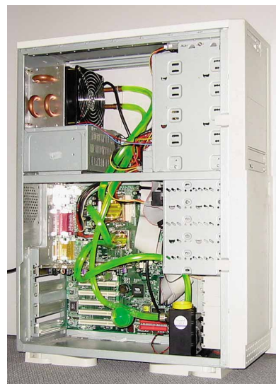
Sieht nicht nur cool aus: Eine sauber aufgebaute Wasserkühlung verhindert Wärmestaus besser als jeder Lüfter.
