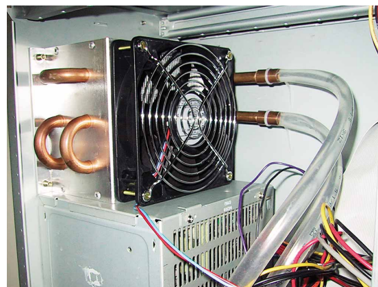
Der Radiator (links oben) übergibt die Abwärme vom Wasser an die Luft, ein langsam drehender 120-mm-Lüfter optimiert das Verfahren.
