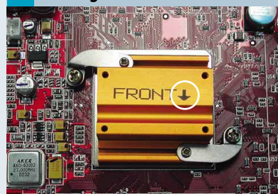
Bild 5: Der Pfeil (weiß eingekreist) muss in Richtung der Steckplatzkontakte des Boards zeigen.
