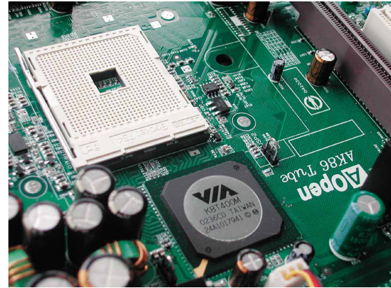
Der neue AMD-Sockel für den Athlon 64 hat satte 754 Anschluss-Pins.
