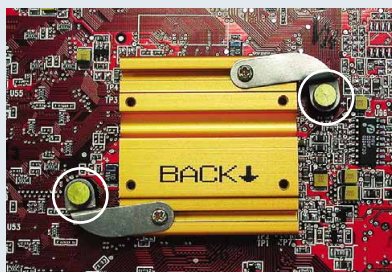
Bild 7: Fixieren Sie den rückwärtigen Kühlblock mit den Verschlusskappen (weiß eingekreist).
