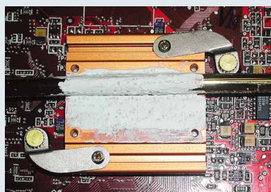
Bild 10: Auch auf der Rückseite verhindert eine dünne Schicht Wärmeleitpaste den Hitzestau.
