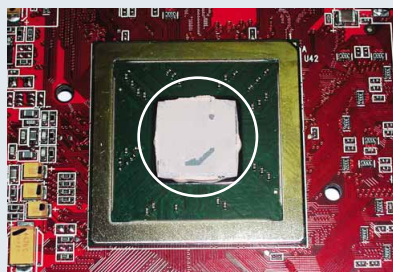
Bild 3: Entfernen Sie die Reste des Heatpads vorsichtig mit einem Tuch und Reinigungsalkohol.
