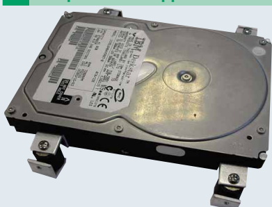
Eine so entkoppelte Festplatte überträgt keine Schwingungen mehr auf das PC-Gehäuse.
