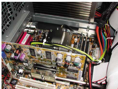
Der Silentium -PC arbeitet lüfterlos. Im Bild sehen Sie die Heatpipes von CPU und Grafikkarte, dazu am oberen Bildrand das Netzteil.
