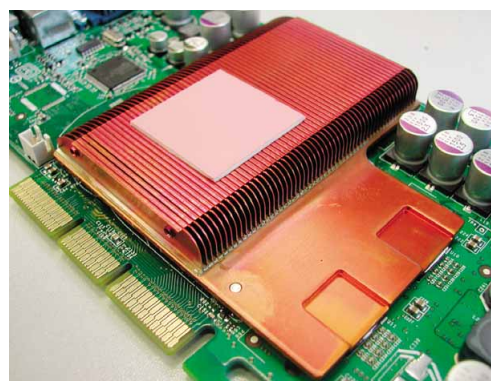
Leadtek verzichtet bei ihrer GeForce 5800 Ultra auf die üblichen drei Heatpipes und verbaut stattdessen einen massiven Kupferkern .
