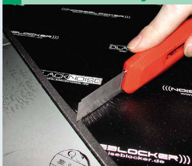
Mit dem Teppichmesser schneiden Sie die Dämmmatten entsprechend der Gehäusegröße zurecht.
