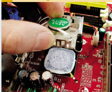
Tauschen Sie einen aktiven Northbridge-Kühler gegen eine passive Lösung, etwa von Zalman.
