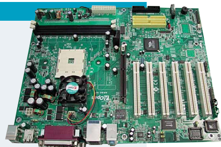
Das Athlon-64-Board AK86-VN-Board von Aopen mit dem neuen Sockel 754 und zwei Bohrlochern zur Kühlerbefestigung.
