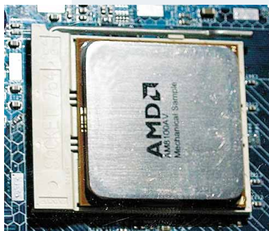
Wie der Pentium 4 hat der kommende Athlon 64 eine Metallhaube für einen besseren Kontakt zum Kühler.
