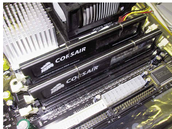
Dual-Channel-DDR nutzt zwei normale DDR-Riegel und verdoppelt so die Speicherbandbreite – moderne CPUs laufen erst mit damit richtig schnell.
