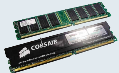
Corsair-Module (vorn) unterstützen im Gegensatz zu Billig-RAM (hinten) problemlos den CL2-Betrieb .
