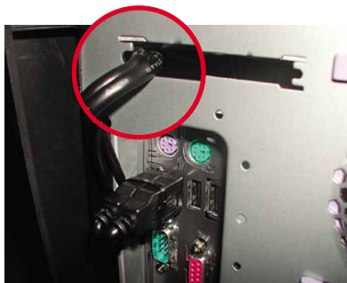
Schlecht verarbeitet: Das USB-Kabel für die vorderen Anschlüsse berührt scharfe Gehäuseteile.
