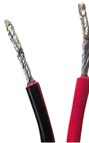
Unterscheidungsmerkmal: Der Plus-Kanal des Boxenkabels ist hier rot gekennzeichnet.
