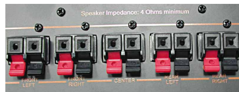
Die meisten Subwoofer haben Klemmverbindungen für Satelliten- und Center-Lautsprecher.
