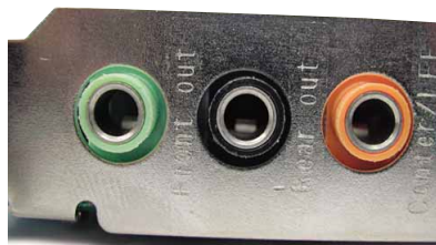
Farbcodierte 5.1-Ausgänge: Grün: Front Speaker; schwarz: Rear Speaker; orange: Bass/Center.
