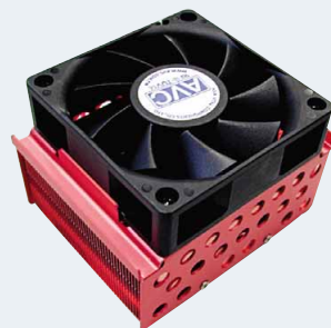
MSI Boxed: Der dem K8T-Master1-Board beigelegte Lüfter ist laut, kühlt aber auch extrem gut. Bei empfindlichem Gehör tauschen Sie den 70-mm-Werkslüfter gegen ein leiseres Exemplar.
