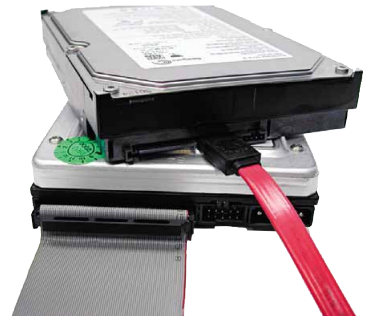
Das moderne Serial-ATA (oben) soll den breitkabeligen Parallel-ATA-Platten den Rang ablaufen.
