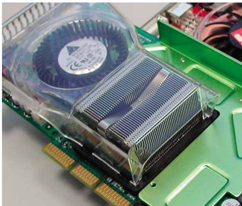
Der martialisch wirkende Lüfter der GeForce FX 5950 Ultra reduziert je nach Temperatur seine Drehzahl und damit die Lautstärke.
