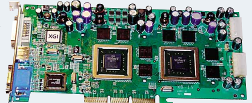
XGI Volari Duo: Zwei DX9-GPUs und 16 Render-Pipes für 390 Euro.
