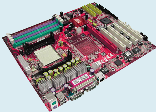
Der Athlon 64 FX erfordert neue Boards wie das MSI K8T Master1. Konkurrent Pentium 4 HT/3,2 GHz Extreme passt auch auf ältere.
