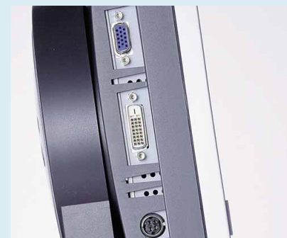
So soll es aussehen: Neben der Standard-VGA-Buchse befindet sich ein digitaler DVI-Anschluss. Hier in der rein digitalen DVI-D-Ausführung.
