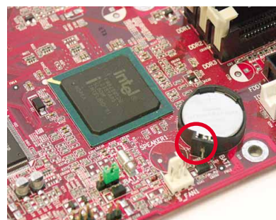
Um die Mainboard-Batterie zu entfernen, müssen Sie die Halterung nach hinten drücken.
