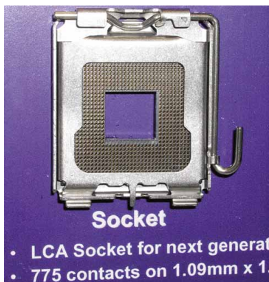
Der neue Pentium für den Sockel 775 hat keine Pins, sondern 775 Anschluss-Bällchen.
