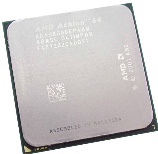
Athlon 64/3800+: Mit 2,4 GHz Takt und Dual-Channel-Speicher-Interface zu sehr guter Leistung.
