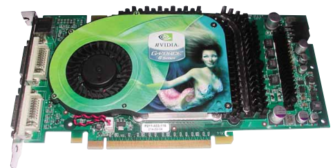
Die hier abgebildete GeForce 6800 GT ist die erste Oberklasse-Grafikkarte mit dem brandneuen PCI-Express-Anschluss.
