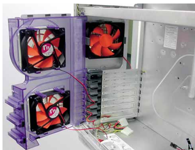
Zwei 90-mm-Lüfter blasen direkt aufs Board.
