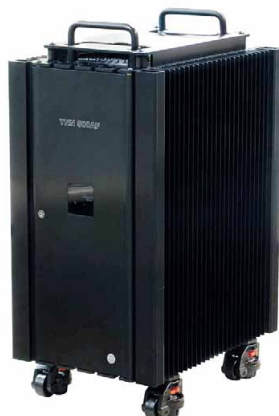
18 Heatpipes für 1.000 Euro: Zalman TNN-500AF mit 18 Heatpipes.
