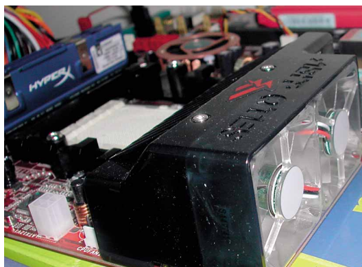
Zwei Lüfter kühlen auf dem AN8 die CPU-Stromversorgung.
