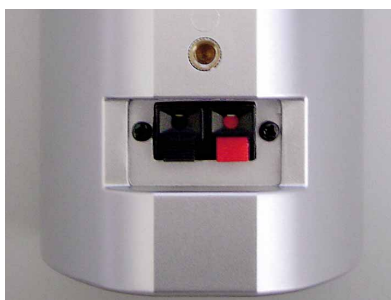
Die Satelliten verbinden Sie per Klemmanschluss.
