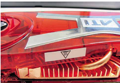
Massiv: Ein Kupferblock führt die Wärme ab.
