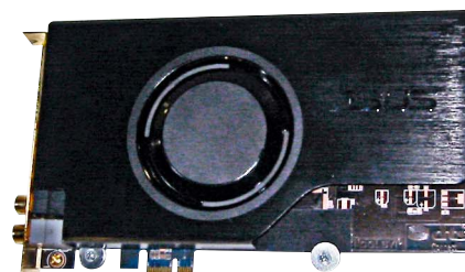
Die Xonar -Abdeckung verbirgt keinen Lüfter, sondern sie soll die Signalqualität verbessern.
