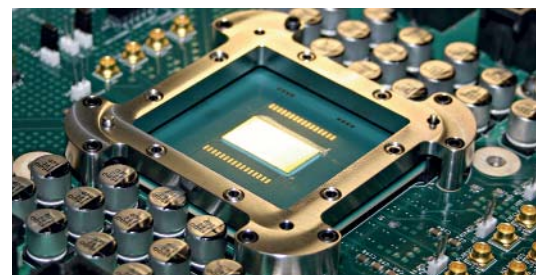
Der Polaris-Chip verbraucht trotz 80 Rechenkernen nur 62 Watt.
