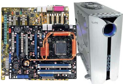
Das Kandalf-Gehäuse von Thermaltake nimmt außer ATX- auch die wesentlich größeren E-ATX-Mainboards (hinten) auf.
