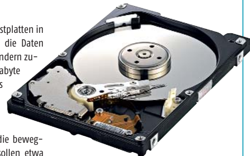
Hybrid-Festplatten speichern Daten auf herkömmlichen Magnetscheiben und in schnellen Flash-Speicher-Modulen.
