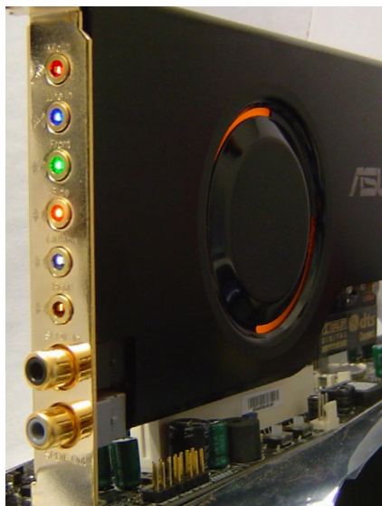
Praktisch: Die analogen Anschlüsse der Xonar D2 leuchten in der passenden Kabelfarbe für Lautsprecher oder Headset.
