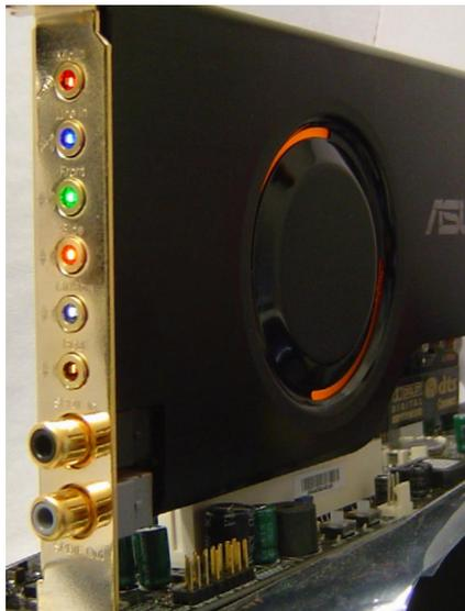
Praktisch: Die analogen Anschlüsse der Xonar D2 leuchten in der passenden Kabelfarbe für Lautsprecher oder Headset.
