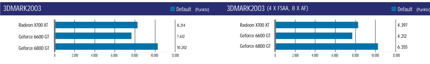
Taiwan im modernen 110-Nanometer-Prozess. Der erlaubt höhere Taktfrequenzen als bisher: ATI treibt den mit 110 Millionen Transistoren vergleichsweise kleinen **X700 XT** auf 475 MHz, Nvidia erreicht beim **6600 GT** trotz satten 146 Millionen Transistoren sogar 500 MHz. Beiden Karten gemein ist die PCI-Express-16x-Schnittstelle und ein 128 MByte großer GDDR3-Speicher. Der auf der 6600 GT läuft mit einem Realtakt von 500 MHz, ATI kitzelt noch schnellere 525 MHz heraus.
