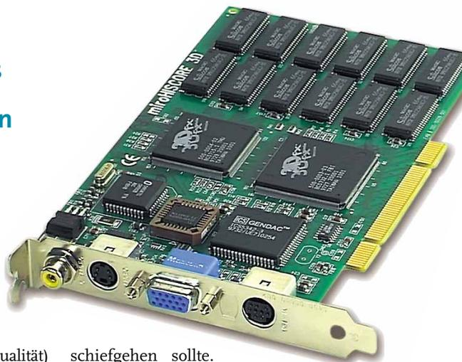
**D**ie Hiscore 3D ist im Prinzip die eingedeutschte Version der hierzulande nicht erhältlichen Canopus Pure 3D. Die Karte mit dem bestens bewährten Voodoo-Graphics-Chipsatz von 3Dfx fällt gleich durch mehrere Besonderheiten auf.
