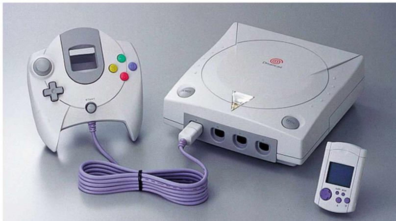
**Dreamcast:** Clou der neuen Sega-Konsole ist das Speicher-Modul mit Display (rechts unten), das außerdem als PDA, Mini-Zweitmonitor und Handheld verwendet werden kann.
