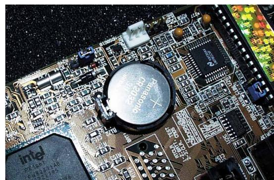
Die Pufferbatterie versorgt sowohl die Bios-Einstellungen als auch die Systemuhr mit der nötigen Energie.
