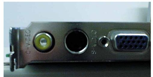
Ganz links befindet sich der Composite-Ausgang an der Miro HiScore 3D, rechts daneben der für S-VHS-sehfachhandel. Die Wiedergabe auf dem Fernsehbildschirm ist genauso flüssig wie auf dem Computermonitor.
