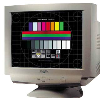
Taxan stattet seinen **Ergovision 745** mit einer Bildröhre von Hitachi aus. Deren sichtbare Bilddiagonale beträgt 40,8 Zentimeter, der Abstand der Lochmaske 0,26 Millimeter. In den Ecken zeigte der Schirm leichte Geometriefehler. Die maximale Bildwiederholrate bei einer Auflösung von 1024 mal 768 Pixeln beträgt gute 117 Hertz. Die Helligkeitsverteilung war sehr gleichmäßig.
