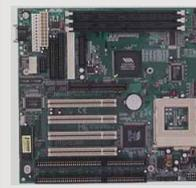
Beim Mainboard-Kauf müssen Sie darauf achten, daß Platine und Gehäuse zusammenpassen, es existieren nämlich zwei unterschiedliche Layouts. Vor gut drei Jahren wurde die ATX-Bauform eingeführt (oben). Dabei hat man das alte AT-Format teils um 90 Grad gekippt; dadurch steht der Prozessor langen Steckkarten nicht mehr im Weg. Außerdem ist ein fester I/O-Bereich für die Schnittstellen integriert, die bei AT größtenteils per Adapterkabel nach außen geführt werden (unten).
