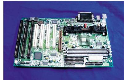
An der Epox-Platine fällt auf Anhieb das durchdachte Layout auf. Zwar setzt die Ausstattung keine Glanzlichter, doch die Anordnung der Elemente kann überzeugen. Die ordentlich beschrifteten Anschlüsse befinden sich vor den DIMM-Sockeln; dementsprechend wenig Kabelsalat haben Sie zu befürchten.
