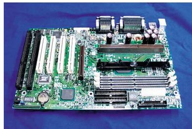
**N**icht nur bei den Prozessoren, sondern auch bei den dazu passenden Mainboards ist Intel deutlich Marktführer. Ein Großteil der Komplett-PCs kommt mit Intel-Platinen ausgestattet daher, obwohl es unter den BX-Modellen bessere gäbe. Das **SE440BX-2** spart an der Ausstattung, war eines der langsameren Boards im Test und quält den Benutzer mit einem Bios von Phoenix. Darin läßt sich so gut wie nichts einstellen; gerade deshalb ist das Board wohl bei Systemintegratoren so beliebt.
