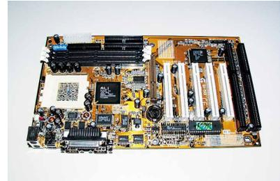
**G**igabyte hat ein Herz für Tüftler: Anstatt der oft nicht nutzbaren 112 MHz der Konkurrenz ist der FSB des **GA-5AX** in Fünferschritten übertaktbar. Auch das Handbuch sowie das durchdachte Layout mit den fünf PCI-Slots und drei DIMM-Sockeln vermögen zu überzeugen. Alle Anschlüsse sind da, wo sie hingehören. Die Kombination aus DIP-Schaltern und Jumpers zur Einstellung der Frequenzen ist dank der guten Dokumentation erträglich.
