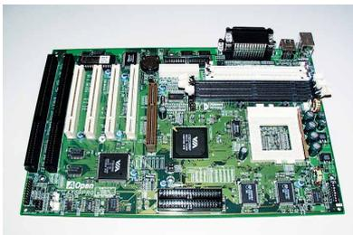
Die Ausstattung des **AX59 Pro** ist bis hin zu den Software-Beigaben sehr gut, doch beim Platinenlayout hat Aopen geschludert. Trotz der Beschränkung auf zwei ISA-Slots fehlt der fünfte PCI-Steckplatz, und Strom- sowie Floppy-Anschluß sind hinter den RAM-Sockeln schlicht fehlplatziert. Ungewöhnlich für ein ATX-Modell sind die zwei zusätzlichen SIMM-Slots für EDO-RAM.
