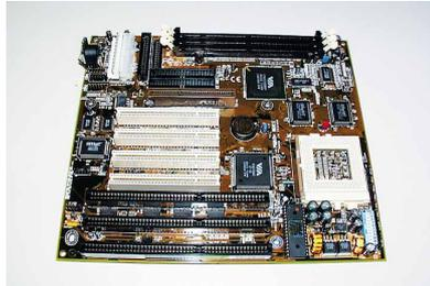
**M**it der aktuellen Revision C seines erfolgreichen Baby-AT-Boards **P5BV3+** wendet sich DFI etwas vom Aufrüster-Publikum ab: Die zwei SIMM-Steckplätze für älteres EDO-RAM wurden zugunsten eines dritten DIMM-Slots für SDRAM wegrationalisiert. Der Prozessortakt wird über einen DIP-Schalterblock halbwegs bequem konfiguriert, die nötigen Stellungen sind sowohl im (ansonsten wenig aussagekräftigen) Handbuch als auch auf einem beigelegten Aufkleber genau erläutert.
