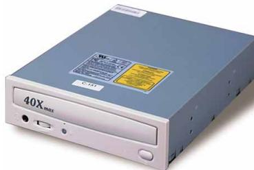
**D**as 40fach-Laufwerk 40X von Cyberdrive glänzt mit der sehr guten mittleren Zugriffszeit von 84 Millisekunden. Die Kehrseite der Medaille zeigt sich allerdings bei der Fehlerkorrektur. Das Atapi-Laufwerk konnte unsere Test-CDs zwar lesen, brauchte dafür jedoch relativ lange und schaltete nach der Korrektur nicht wieder auf die höchste Drehzahl zurück.
