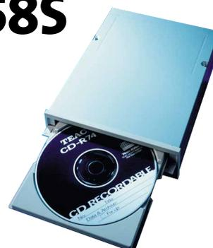
Teacs neuer CD-R-Brenner zählt mit dem in Ausgabe 5/99 getesteten Plextor-Brenner zu den schnellsten erhältlichen Geräten. 24fache Lese- und 8fache Schreibgeschwindigkeit sowie 4 MByte Datenpuffer sind die Eckdaten des 780 Mark teuren SCSI-Gerätes. Unsere Test-Audio-CD beschrieb er in lediglich 9:20 Minuten, die Daten-CD in 10:20 – beides hervorragende Werte.
