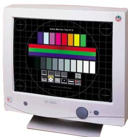
Der **Conmark M1900** von Conrad ist mit einer Teco-Bildröhre (0,26-Millimeter-Lochmaske, 46 Zentimeter sichtbare Bilddiagonale) ausgestattet und trägt das TCO-95-Siegel. Alle Einstellungen sind im übersichtlichen Bildschirmmenü zu erreichen, zusätzlich steht für den Kontrast ein eigener Drehregler zur Verfügung. Die Bildhelligkeit war bei unserem Testgerät etwas ungleichmäßig verteilt. In der unteren Schirmhälfte konnten wir leichte Konvergenz- und Geometriefehler feststellen.
