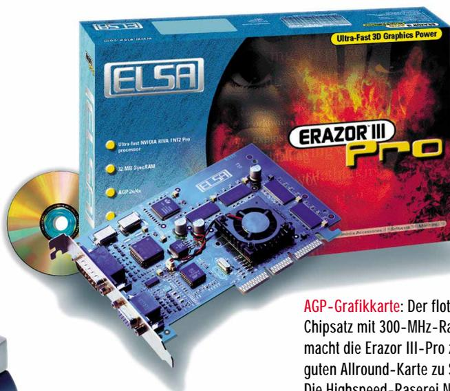
**AGP-Grafikkarte:** Der flotte TNT2-Chipsatz mit 300-MHz-Ramdac macht die Erazor III-Pro zu einer guten Allround-Karte zu Spieler. Die Highspeed-Raserei Need for Speed 4 gehört mit einigen Grafikprogrammen wie Corel Draw 7 zum Lieferumfang. Dank Video-Ausgang und beigelegter Bearbeitungssoftware eignet sich die Karte auch für den heimischen Videoschnitt. Wert der Karten: etwa 4.000 Mark.
