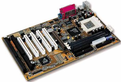
Mit dem **GA-5AX** bietet Gigabyte ein ideal zum Übertakten geeignetes Sockel-7-Board mit **Aladdin V**-Chipsatz an. Neben Bustakraten von 66, 95 und 100 MHz lässt sich die Platine per Jumper auch auf 75, 83, 105, 110, 115, 120, 125, 130, 135 oder 140 MHz einstellen. Die Multiplikatoren reichen bis 6fach, die CPU-Spannung von 1,3 bis 3,5 Volt. Damit ist der Anwender auch für noch kommende Sockel-7-CPU's gerüstet.
