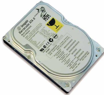
Die Seagate **Barracuda ATA II 20.4** (ST320420A) bietet eine Speicherkapazität von 20,4 GByte und läuft mit 7.200 Umdrehungen pro Minute. Im GameStar-Testlabor erreichte die Platte eine mittlere gemessene Zugriffszeit von 13,8 Millisekunden und eine durchschnittliche Datentransferrate von 25,3 MByte pro Sekunde – damit ist sie der derzeit schnellste IDE-Drive am Markt. Die CPU-Auslastung blieb während der Tests unter 5 Prozent.
