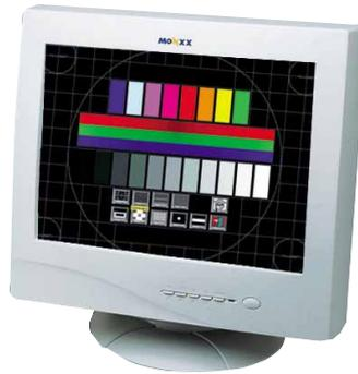
Monxx, die Low-Cost-Marke von Maxdata, präsentiert mit dem nur 400 Mark teuren Modell **770** einen Monitor nach TCO-99-Strahlungsnorm mit 0,27-Millimeter-Lochmaske. Trotz gleichmäßiger Helligkeitsverteilung ist die Bildqualität nur durchschnittlich – das liegt an Verzerrungen in der linken oberen Bildschirmcke sowie Geometriefehlern in der rechten unteren. Mit 85 Hz bei einer Auflösung von 1024 mal 768 Pixels ist die Bildwiederholrate augenfreundlich.
