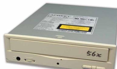
Das neue 56fach CD-ROM-Laufwerk von Afreedy verfügt über ein UDMA/33-Interface und einen internen Cache von 128 KByte. Die Testresultate des **CD-2056E** im GameStar-Testlabor fielen insgesamt überzeugend aus. Denn eine durchschnittliche Datentransferrate von 5.960 KByte pro Sekunde, also 39,8fach, sowie eine gemessene mittlere Zugriffszeit von 75 Millisekunden sprechen für sich. Einziger Kritikpunkt ist das Auslesen von CD-RW-Medien, das lediglich mit 8facher Geschwindigkeit erfolgt.
