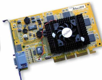
**E**twa viermal so groß wie der eigentliche Chip ist der imposante Lüfter auf der **Winfast Geforce 2 GTS** von Leadtek. Dennoch halten ihn unverständlicherweise nur zwei kleine Plastikklammern auf der Oberfläche, eine feste Verklebung war beim Testmodell nicht vorhanden. Ein schnöder Materialbruch kann so den Hitzetod für den teuren Grafik-Chip bedeuten oder eventuell darunterliegende Karten beschädigen.
