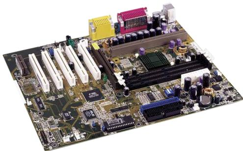
Auf den **VIA KX 133** als Steuerbaustein setzt das Athlon-Mainboard **Asus K7V**. Damit ist es einen Tick langsamer als Konkurrenten mit dem **AMD 751**-Chipsatz. Als Besonderheit bringt die Platine einen AGP-Pro-Steckplatz mit, der dafür konzipierte Grafikkarten mit einer zusätzlichen Stromversorgung stabilisiert. Die restliche Ausstattung ist mit fünf PCI-Slots (ISA-Slots fehlen leider), einem AC97 Audio-Codec und drei Speicherbänken guter Durchschnitt.
