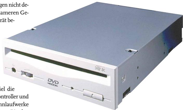
also Festplatte als Primary-Master und CD- oder DVD-ROM als Secondary-Master. Zusätzliche Geräte sollten Sie nur an den jeweiligen Strang hängen, also CD-Laufwerke ebenfalls an den Secondary-Port und Festplatten an den Primary. Am elegantesten lösen Sie das Problem mit einem zweiten **ATA-100-Controller**, an dem Sie nur die Festplatten betreiben. Alle anderen Geräte können am internen Controller verbleiben. Ein ungewolltes Ausbremsen der Festplatte ist somit nicht möglich.
