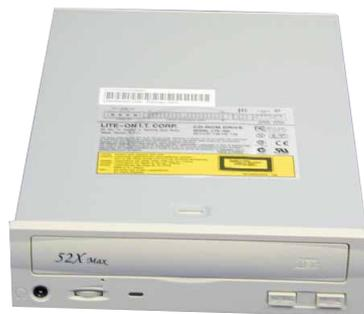
Modus mit älteren, langsamen CD-ROM-Laufwerken am selben IDE-Strang. Ein CD-ROM mit antiquiertem **PIO-Mode<sup>4</sup>** 3 oder 4 bremst die Festplatte am gleichen Strang brachial auf das eigene Tempo herunter. Selbst brandneue DVD-Laufwerke, die ebenfalls mit **UDMA-66** arbeiten, können unter ungünstigen Bedingungen die Leistung der Festplatte reduzieren. Der beste Schutz ist das durchdachte Platzieren der einzelnen IDE-Geräte.
