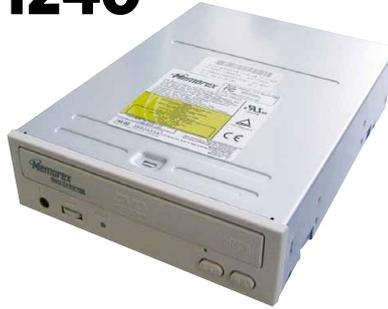
Mit dem **DVD Maxx 1240** präsentiert Memorex ein neues 12fach-DVD-Laufwerk mit 40facher CD-Lesegeschwindigkeit. Das Gerät hat einen Cachespeicher von 512 KByte und eine UDMA/33-Schnittstelle. Schon bei der Ausstattung kann das Laufwerk punkten: Es verfügt über separate Tipptasten für Audio-CDs; Teil des Lieferumfangs ist neben einem Audiokabel auch **Power DVD 2.55** von Cyberlink.
