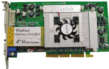
**A**uch Leadtek bietet jetzt eine Grafikkarte mit Geforce-2-Ultra-Chip von Nvidia: die **Winfast Geforce 2 Ultra**. Die Karte besitzt 64MByte schnellen DDR-RAMs und 460 MHz Speichertakt. Die Taktfrequenz des Chips beträgt 250 MHz. Für Kühlung sorgt ein sehr großer aktiver Lüfter; der Speicher ist auch mit passiver Kühlung versehen.
