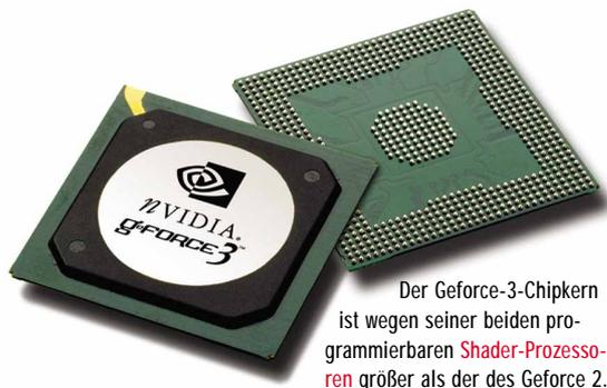
Der Geforce-3-Chipkern ist wegen seiner beiden programmierbaren Shader-Prozessoren größer als der des Geforce 2.
