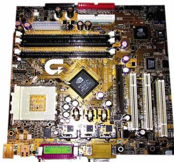
Erste Mainboard-Prototypen mit Nvidias Nforce setzen fast alle auf das Micro-ATX-Format.
