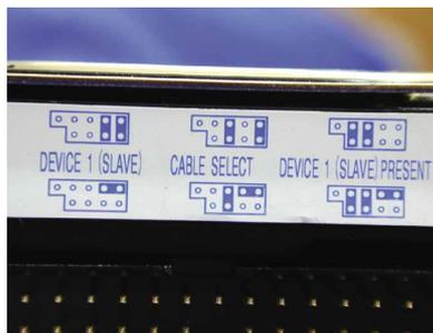
Der **Jumper-Block** einer IBM-Platte: Hier finden Sie die richtige Einstellung für den Betrieb von zwei Platten an einem IDE-Computer-Strang.
