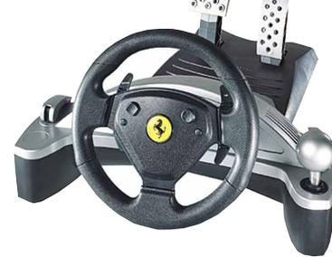
**D**as **360 Modena Pro** verzichtet auf Force Feedback, ist aber ansonsten komplett ausgestattet: Die Gangwechsel erfolgen wahlweise per Schalthebel oder über zwei am Lenkrad angebrachte Wippen. Weiter finden sich zwei programmierbare Knöpfe, ein Steuerkreuz sowie ein Cooliehat. Auf Wunsch übernehmen zwei Regler die Funktion von Gas und Bremse – die Pedalerie wird dann überflüssig.
